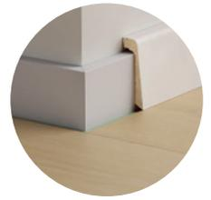
Streichbare Sockelleiste, die in zwei Formen für mehr Dekorationsmöglichkeiten verwendet werden kann. Anpassbar an 5 Höhen zwischen 25 und 134 mm – nutzen Sie zum Zuschneiden das mitgelieferte Incizo Messer. Kann auch weiß gelassen werden. Mit dem One4All-Klebstoff einfach zu verlegen. Nicht geeignet für feuchte Räume – sehen Sie sich hierfür unsere wasserfesten Sockelleisten an.
